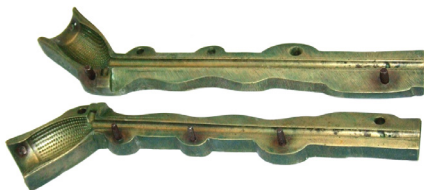
7. Dwuczęściowa forma do produkcji jednorodnych fajek glinianych z XIX wieku (zabytek ze zbiorów De Tiendschuur Museum w Weert w Holandii)
