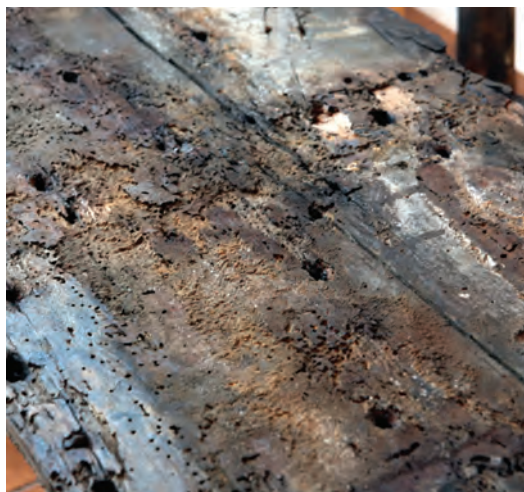
Fot. 2. Powierzchnia wieka skrzyni po zdjęciu okuć żelaznych. Widoczne uszkodzenia spowodowane działaniem owadów i kontaktem żelaza z drewnem
