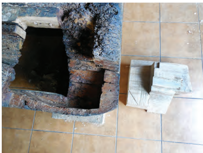
Fot. 4. Uformowany flek z drewna dębowego przed wklejeniem w narożnik skrzyni
