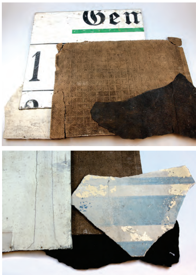
Fot. 8 a i b. Zachowane fragmenty materiałów wypełniających ściany szkieletowe kościoła z Bytomia-Bobrza – strony zewnętrzna (a) i wewnętrzną (b)
