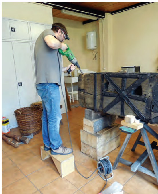
Fot. 7. Pobieranie próbki drewna do badań dendrochronologicznych
