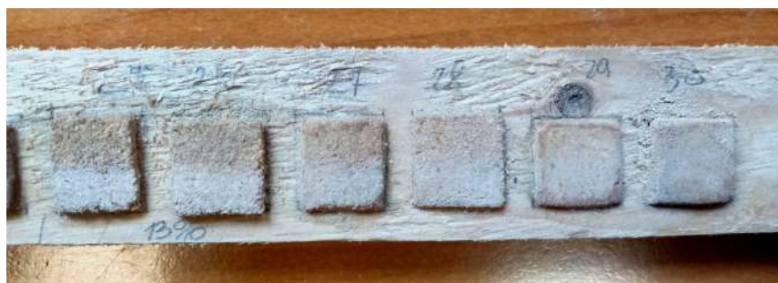
Ryc. 7. Próby z 13-procentowym klejem skórny
