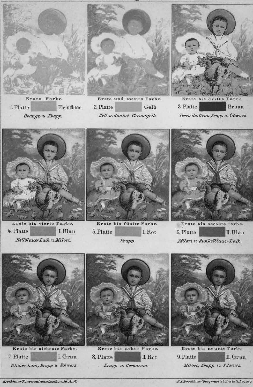
Fot. 2. Etapy wykonywania chromolitografii 9-kolorowej, karta z: Brockhaus Konversations-Lexicon, początek XX wieku
