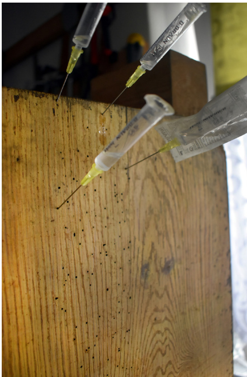
Fot. 6. Fragment komody podczas impregnacji poprzez iniekcję swobodną
